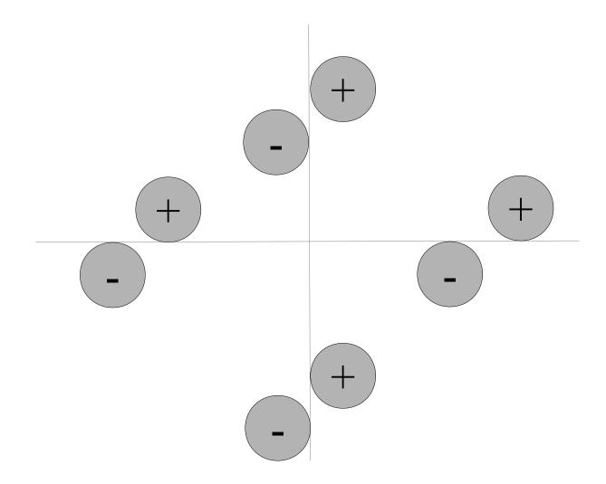
MATCH THE POSITION OF YOUR EDGEFINDER IN RELATION TO THE LOCATION EDGE TO THE CORRESPONDING CIRCLE IN THE CHART ABOVE TO DETERMINE IF YOUR EDGEFINDER IS ON THE POSITVE OR NEGATIVE SIDE OF THE LOCATION EDGE.
